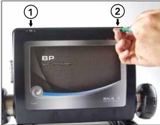
– Utilisez un tour Nevis Phillips pour enlever les 2 vis de dessus qui tient la couverture du système en place.
